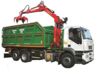
Autocarri scarrabile con pinza di carico
